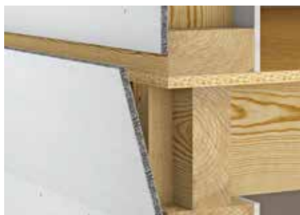
Montage des Plattenstreifens
